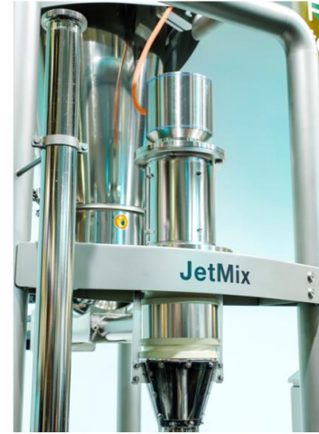
AKMH paslanmaz çelik motorlar sadece tek bir kabloyla geri iletim dahil olmak üzere AKD servo regülatöre bağlanmaktadır. Paslanmaz çelik motorları geniş ayar aralığı sayesinde farklı hızlara göre rahatça ayarlanabilir.
