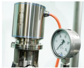
Servo motorların tek kablolu bağlantı teknolojisi hijyen açısından pek çok avantajı beraberinde getiriyor.
